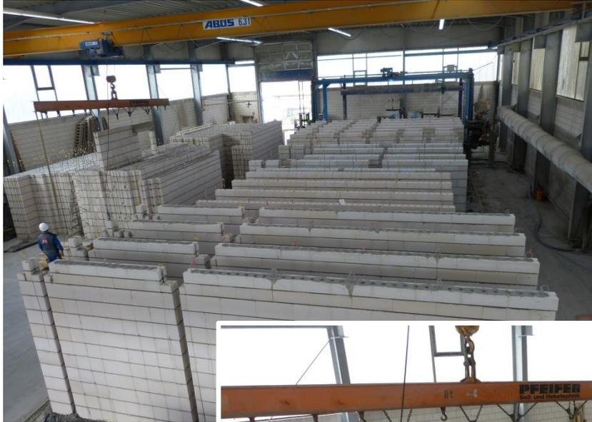
Die Mauertafeln werden mit Hilfe der Traverse auf den Tieflader mit A-Bock-Aufsatz verladen.
