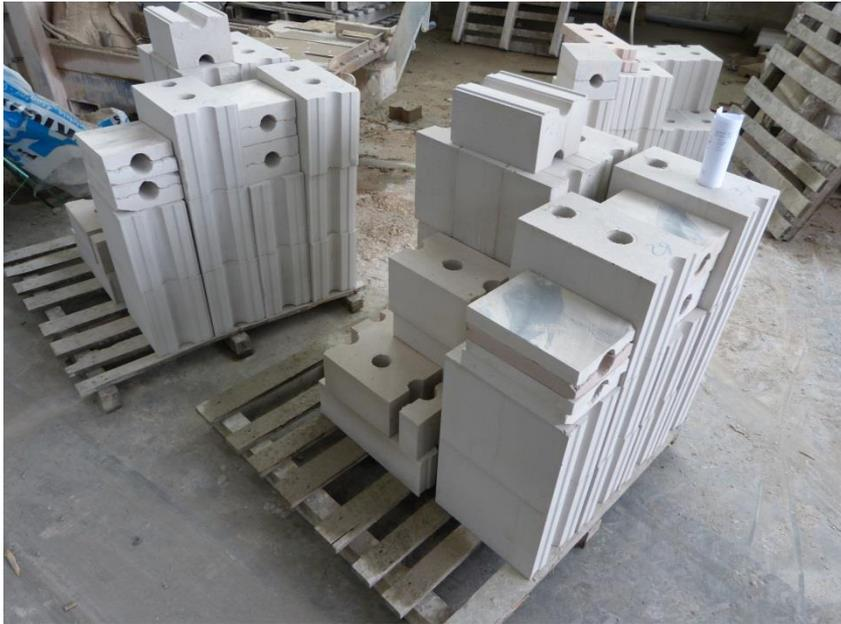
Fertigung und Bereitstellung von Schnittsteinen auf Basis der Wandpläne.
