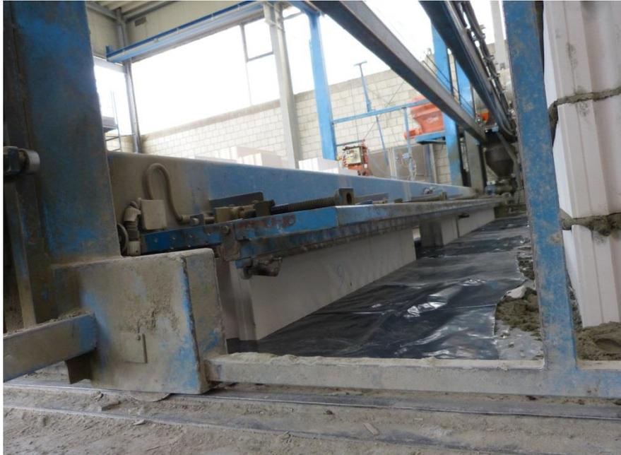
Die Mauermaschine setzt die erste Steinschicht.
