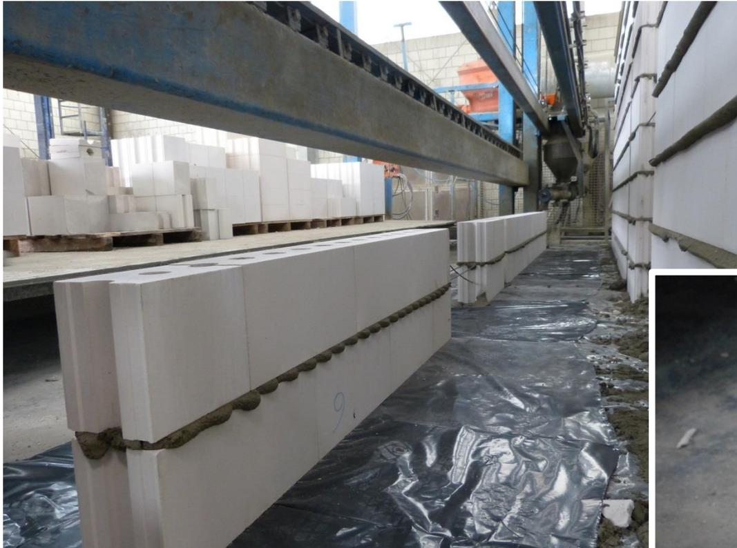
Die zweite Steinschicht wird durch die Mauermaschine gesetzt.
